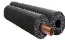
Deverá ser utilizado espuma elastomérica à base de borracha sintética, com classificação ao fogo M-1 (UNE-23727), resistência ao vapor de água μ7.000, de fabricação EPEX, ou ARMACELL tipo AF/ARMAFLEX, nas espessuras mínimas abaixo indicadas.
