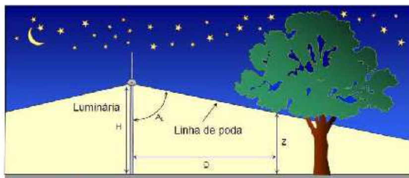
Figura 1 - esquema de adequação de altura de poste em praças
